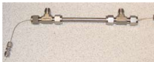
Figur 2. MIMS-enhet, demontert fra GC/MS-systemet, der gasskromatografen kan brukes til både heliumgass-kontroll og termostatering. Den er bygget av standard-komponenter og inneholder en ca. 10 cm lang polydimetylsiloksan-slange som membran. På T-koblingene tilkobles ledningene som prøven transporteres til og fra membran-yttersiden, mens de tynne metallkapillærene tilfører helium (venstre rør her) og tilkobles massespektrometeret (høyre rør).
