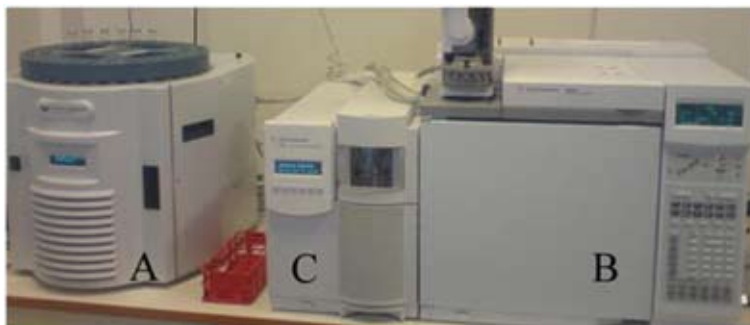
Figur 1. A) Teledyne Tekmar HT3 headspace; B) Gasskromatograf og C) Massespektrometer. (Foto: Camilla E. Jørgensen).
