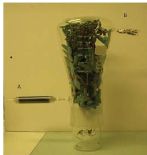
Figur 1. Lukttoppsamling av rogn med dynamisk headspace. A: Kullfilter for rensing av luft. B: Filter med adsorbsjonsmiddel.
